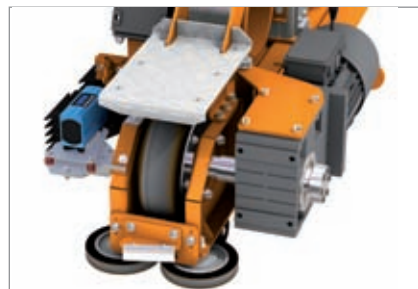
Detalle de las ruedas de contraste y del grupo de traslación.
