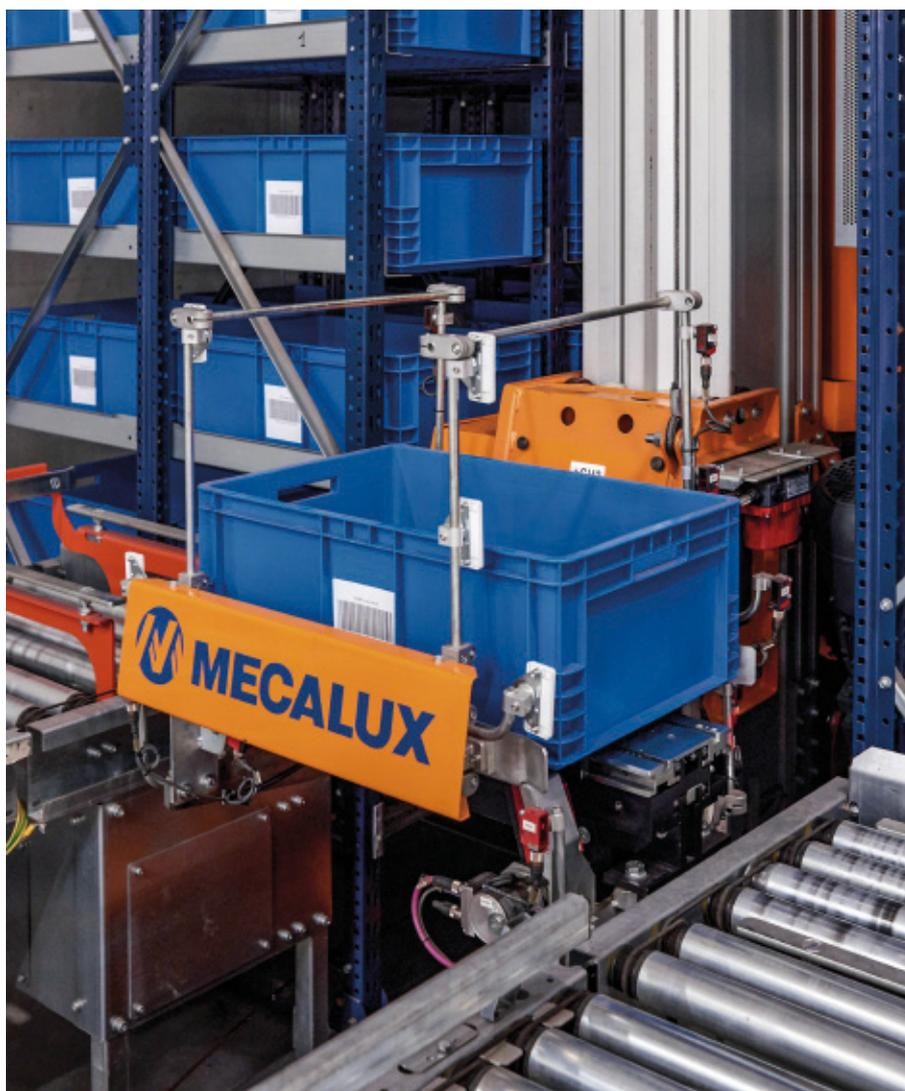
Teniendo esto en cuenta, Mecalux propuso instalar un almacén automático de cajas miniload. Se trata de un sistema de almacenaje para productos de pequeñas dimensiones, diseñado específicamente para facilitar la gestión automática de la mercancía y la preparación de pedidos. De ese modo, se cumplirían los dos principales requisitos de Symta-Pièces: *“para nuestro nuevo almacén, queríamos optimizar el espacio de almacenaje y agilizar las operativas”*, señala Dominique Praud.
