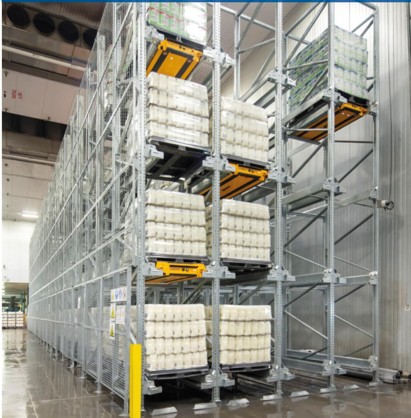
El proveedor y distribuidor de productos lácteos Producers Dairy ha equipado su cámara de refrigeración de 4.645 m<sup>2</sup> en la planta de producción que posee en California con el sistema Pallet Shuttle semiautomático de Interlake Mecalux. La firma ha sustituido sus anteriores estanterías de paletización, que se habían quedado obsoletas, con el sistema Pallet Shuttle. Con esta solución, la compañía ha duplicado la capacidad de almacenaje y puede preparar hasta 300 pedidos al día.
