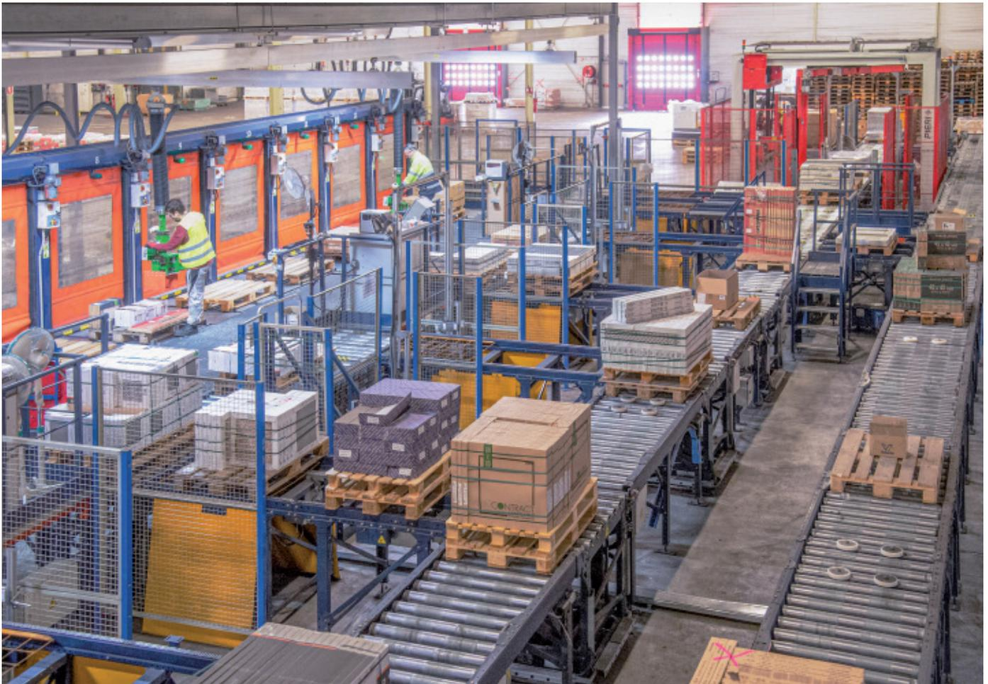
dosas de cerámica son productos pesados y voluminosos. Ante tal desafío, Mecalux habilitó una zona de preparación de pedidos compuesta por transportadores, lanzaderas y puestos de picking con equipos de manipulación que facilitan el trabajo de los operarios.
