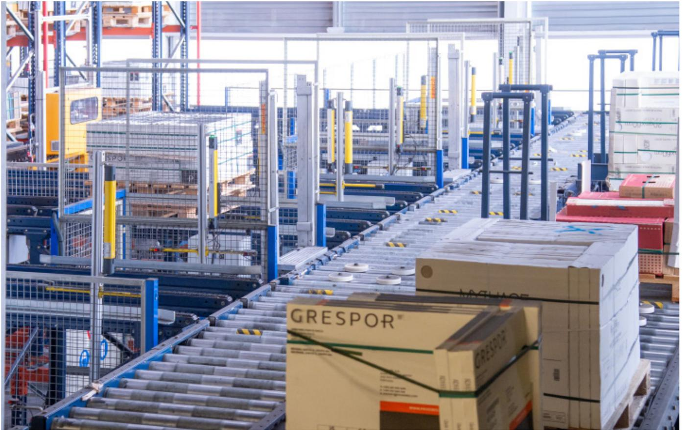
La operativa del nuevo almacén de VM Matériaux es completamente automática: tres transelevadores introducen y extraen la mercancía de sus ubicaciones con total autonomía. El almacén, con capacidad para más de 5.700 palets, destaca por la longitud de sus pasillos de almacenaje –95 m–.
