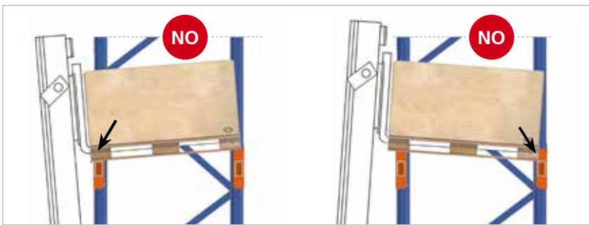
Figura 9. Sobrecarga sobre una viga por descenso no horizontal
